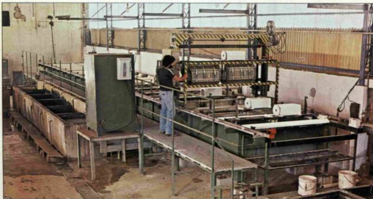
Instalação para zinco (tambores rotativos) com carro transportador - Produção horário: 1 200 kg
