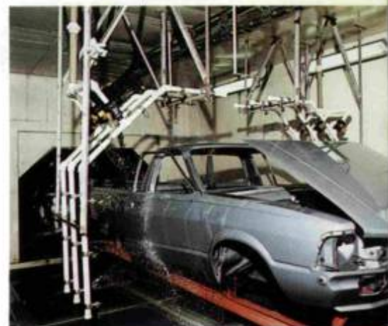
Entrada da carroceria na área de pintura.
