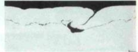
Fig. 143: Secção metalográfica através de um local de falha (sem ataque)
