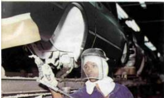
Aplicação do vedador do PVC nas partes inferiores da carroceria
