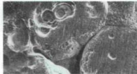
Fig. 142: Textura superficial do revestimento de níquel, após remoção dos produtos de corrosão (Detalhe do campo ilustrado na fig. 141)
