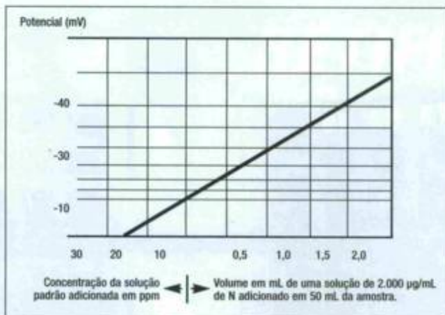
Fig 1 - Exemplo de um gráfico para determinação da concentração de sulfato de amônio em banhos de zinco ácidos (Dailide & Shelter, 1982).
