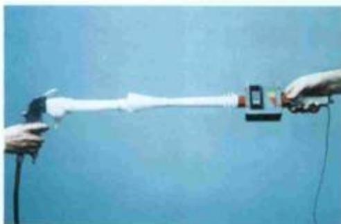
O medidor de alta tensão eletrostático modelo TCA-MRE, desenvolvido pela **Tecnoavance**, permite que se saiba como está o equipamento de pintura, através da leitura digital de rendimento eletrostático na pistola de pintura. A leitura é direta e mostra em qual faixa de funcionamento se encontra: normal (70 a 100%); manutenção preventiva (50 a 70%) e manutenção corretiva (0 a 50%). Atua com faixa de leitura até 1000 kV, negativo, e impedância de entrada de 3000 megaohms ou 3 gigaohms.
