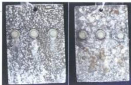
Foto 12 e 13 - Selantes especiais para evitar corrosão por par galvânico
