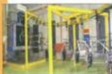
Transportador com dispositivo para pintura
