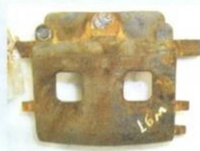
**Foto 7 - Pintura epóxi 1000 h em névoa salina**
