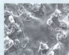
d Substrato de rugosidade Ry 50/60 µm com preaquecimento.
