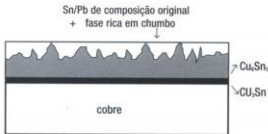
Fig. 3 - Ilustração esquemática da seção transversal de uma camada de estanho/chumbo aplicado sobre cobre após envelhecimento a altas temperaturas
