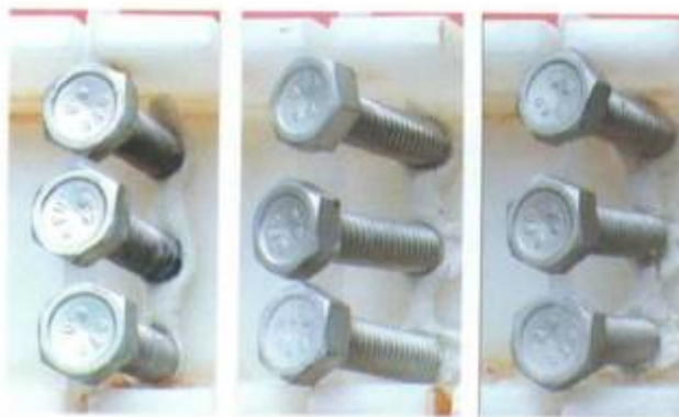
Resultados dos ensaios de corrosão → 44 boras (tratamento térmico 150 °C por 1 hora)
