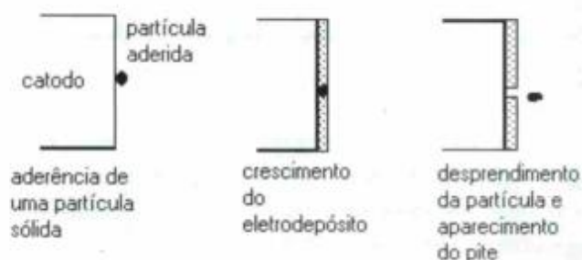
Figura 2 - Ilustração esquemática da formação de depósitos com pites devido à presença de partículas sólidas no banho
