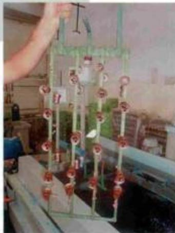
O Systocopper 2000, da **Tecnorevest**, é um processo de cobre alcalino, isento de cianetos, para aplicação em ferro, Zamak e latão, proporcionando aderência e preparação para posteriores deposições de cobre ácido, níquel, cromo, metais preciosos e outros. Pode ser usado em gancheiras e tambores rotativos.
