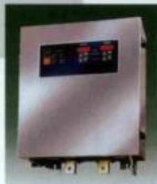
Dentro da linha de retificadores industriais fabricados pela **Adelco** estão equipamentos para eletrodeposição de cromo, níquel e ouro, assim como para eletrólise e eletroforese. Podem ser fornecidos nos tipos linear, em módulos de 0-12 VCC/1 000 A e com refrigeração a água, e pulsado, totalmente microprocessados e com IBGT, apresentando corrente de saída e largura dos pulsos ajustáveis nos modos direto e reverso.
