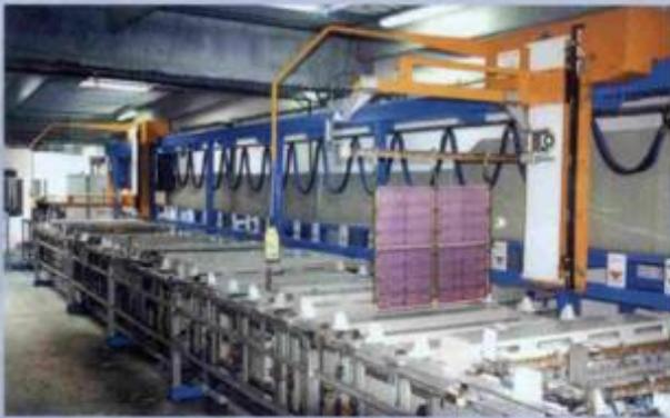
*Equipamento para metalização de placas de circuito impresso*
