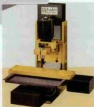
A fresadora CNC1000, da **Electrogold**, opera com três ou quatro eixos e corta alumínio, grafite, plástico rígido, cera, magnésio, bronze e madeira. Apresenta área de trabalho de 10x25x10 cm e opera em regime de 3.000 a 20.000 rpm.
