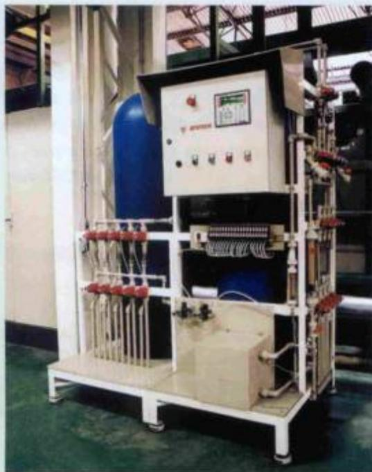
*O Nikotect remove a contaminação dos banhos de níquel*
