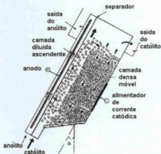
Figura 3 - Esquema do reator do leito circulante de partículas.
