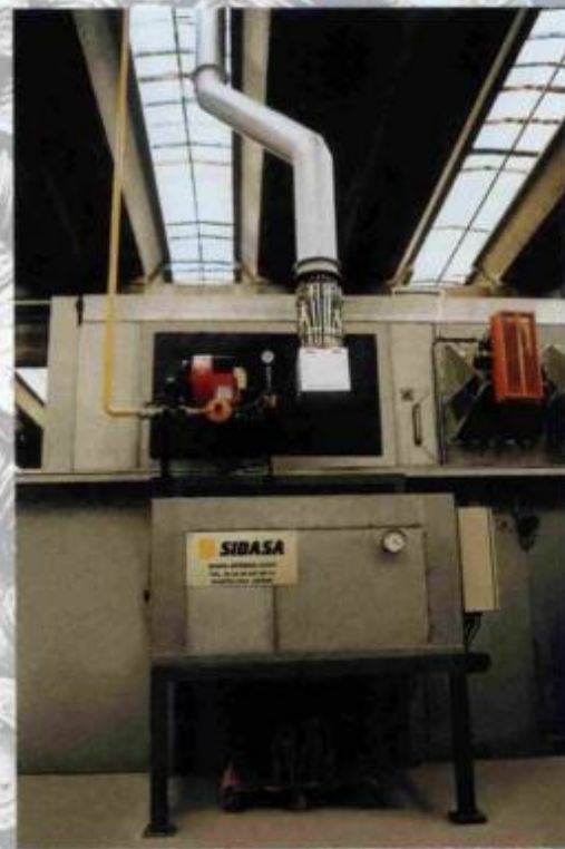
Equipamento de baixo consumo de energia, reaproveitando o calor das chaminés
