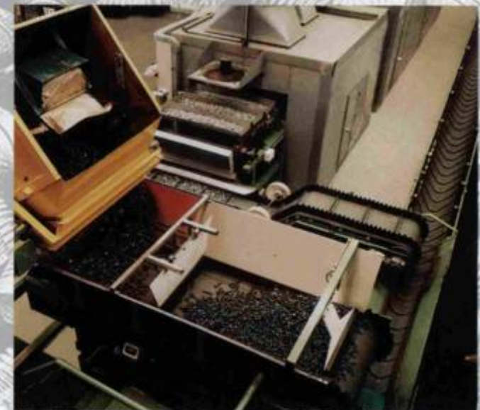
Dosificação automática: todas as cargas são exatamente iguais.
