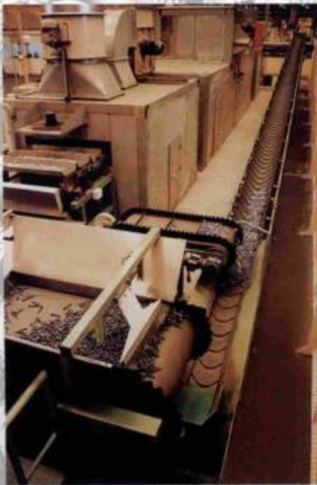
Transportador automático enviando da zona de dosagem para a de "dip-spin"
