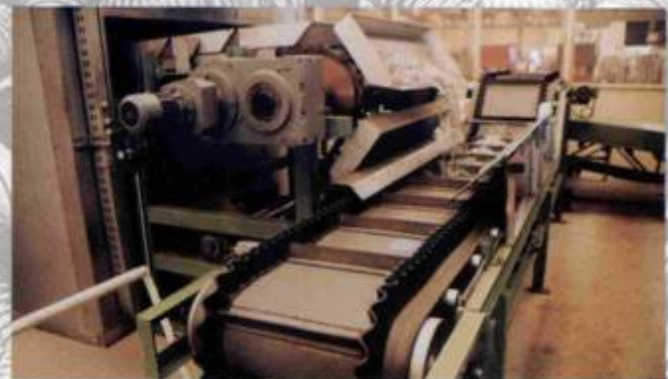
Esteira em borracha vulcanizada, com a função de não danificar as peças
