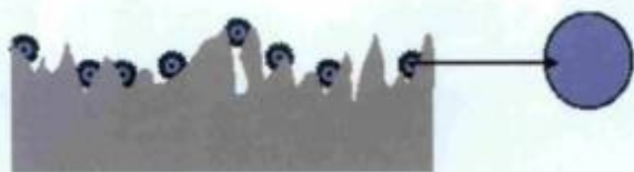
Fig. 3 - Absorção de paládio/estanho na superfície
