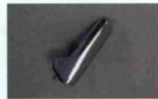
Foto VII: Estágio final, após deposição de níquel e cromo.
