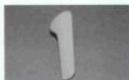
Foto III: Trinco de poliamida para porta de automóvel. Após condicionamento.
