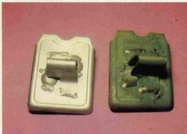
Preparação de aderência de borracha numa superfície metálica
