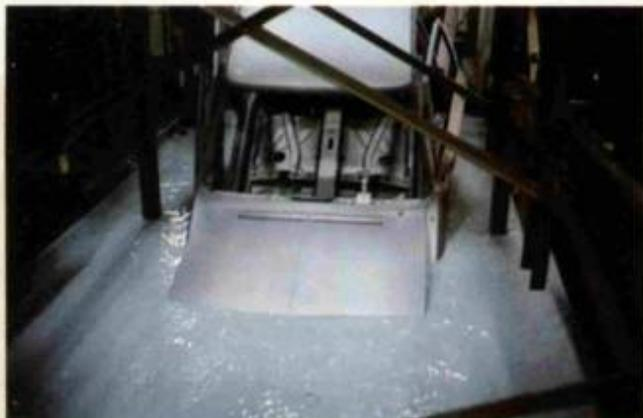
Cathodip® é a tinta de eletrodeposição catódica da Glasurit, que, aplicada à peça limpa e fosfatizada, através da migração das partículas no meio coloidal, forma uma camada compacta e uniforme. As propriedades anticorrosivas de Cathodip®, devem-se à sua concepção de polímeros não saponificáveis, que, juntamente com pigmentos especiais, tornam a tinta muito mais aderente, proporcionando:
