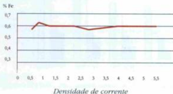
Figura 3: Fe em função da densidade de corrente (A/dm²) Temperatura = 20°C
