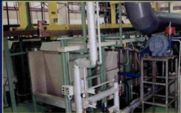
LINHA AUTOMÁTICA DE NÍQUEL-CROMO COM AQUECIMENTO A VAPOR EM GANCHEIRAS
