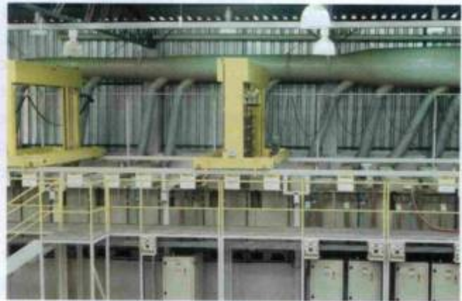
Equipamento automático da Cation para aplicação do processo de zinco-níquel
