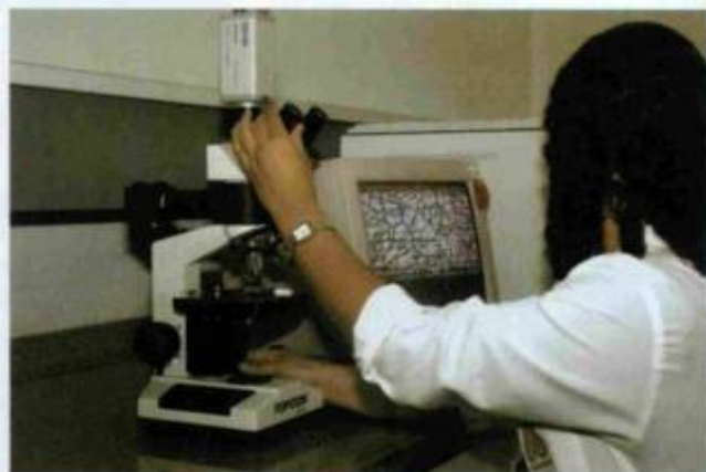
Controle de microfissuras através do microscópio
