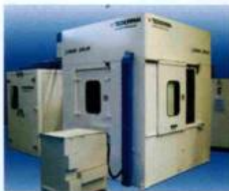
EQUIPAMENTO DE LAVAÇÃO E REBARBAÇÃO ROBOTIZADO
