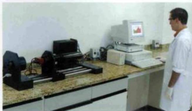
Laboratório instrumental: determinação de coeficiente de atrito
