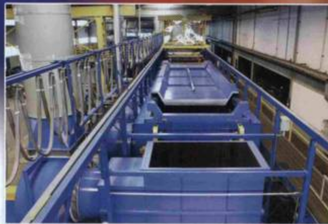
ESTUFA DE CURA MODULAR COM 4 ESTÁGIOS DE TEMPERATURA, TAMPAS DESLIZANTES, TRANSPORTADOR INTERNO E CORTINA DE AR
