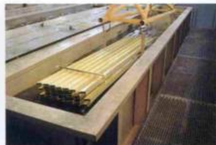
Tanque de cromatização de peças de alumínio
