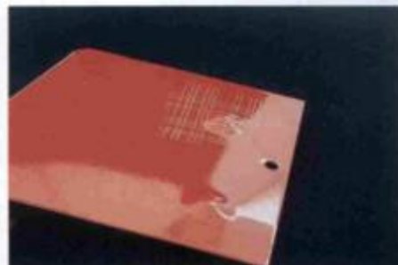
Teste de corte cruzado NBR 14622
