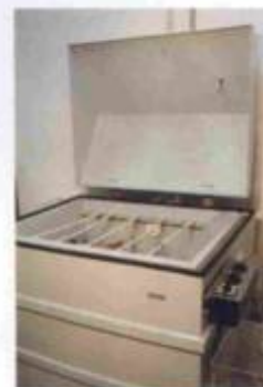
Teste de névoa salina ácida NBR 14905
