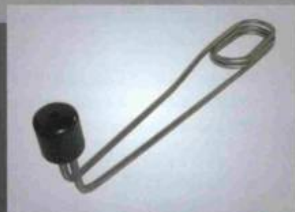
Resistência "Sobre a Borda", \phi 9 mm ou 11 mm, em aço inox AISI-304 ou 316L, revestida em chumbo puro, anti-moniaco ou PTFE.
