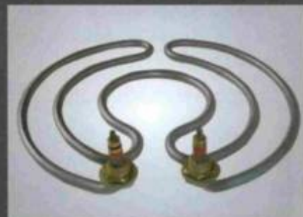
Resistência "Centrifuga" \phi 9 mm, em aço inox AISI-304, de 1,5 KW a 3,0 KW, pontas retas ou dobradas em 90°, com buchas de fixação 5/8" NF.
