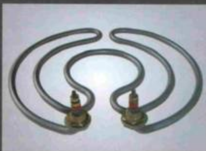
Resistência "Centrifuga" \varnothing 9 mm, em aço inox AISI-304, de 1,5 KW a 3,0 KW, pontas retas ou dobradas em 90°, com buchas de fixação 5/8" NF.
