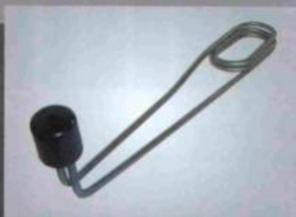
Resistência "Sobre a Borda", \varnothing 9 mm ou 11 mm, em aço inox AISI-304 ou 316L, revestida em chumbo puro, antimoniado ou PTFE.
