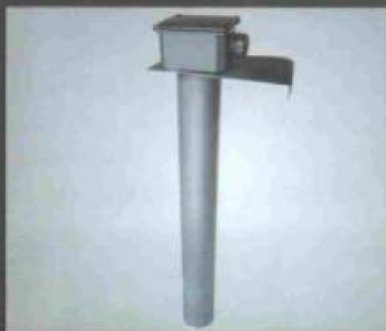
Resistência "Encamisada", em aço inox AISI-316L, com ø 76,20 mm externo, com 6 elementos resistivos em aço inox AISI 304, ø 9 mm. (Indicada para Fosfato)
