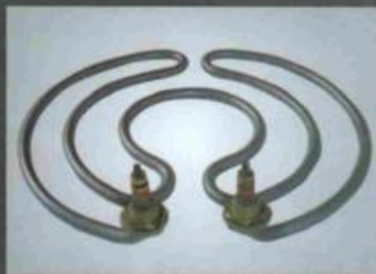
Resistência "Centrifuga" ø 9 mm, em aço inox AISI-304, de 1,5 KW a 3,0 KW, pontas retas ou dobradas em 90°, com buchas de fixação 5/8" NF.
