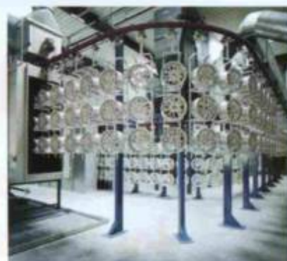
Entrada das rodas em túnel do pré-tratamento
