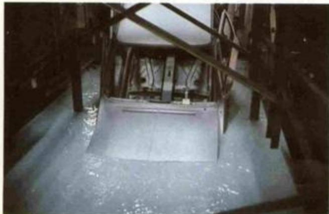
Cathodip® é a tinta de eletrodeposição catódica da Glasurit, que, aplicada à peça limpa e fosfatada, através da migração das partículas no meio coloidal, forma uma camada compacta e uniforme. As propriedades anticorrosivas de Cathodip®, devem-se à sua concepção de polímeros não saponificáveis, que, juntamente com pigmentos especiais, tornam a tinta muito mais aderente, proporcionando:
