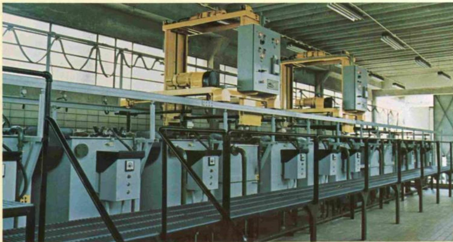
Quando se trata de galvanoplastia, anodização, fosfatização, etc. - as instalações automáticas da Elquimbra, operadas por circuitos eletromagnéticos, asseguram lucrativas vantagens.
