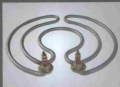
Resistência "Centrifuga" \phi 9 mm, em aço inox AISI-304, de 1,5 KW a 3,0 KW, pontas retas ou dobradas em 90°, com buchas de fixação 5/8" NF.
