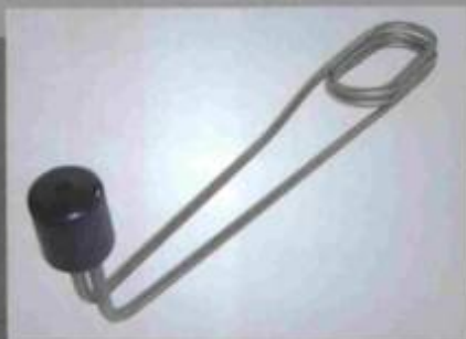
Resistência "Sobre a Borda", \phi 9 mm ou 11 mm, em aço inox AISI-304 ou 316L, revestida em chumbo puro, antimônio ou PTFE.
