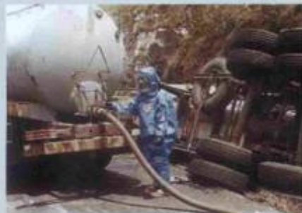
Operação de transbordo de produto químico perigoso
