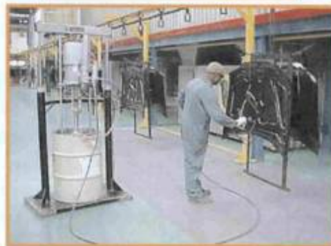
Aplicação de selantes a base de PVC
