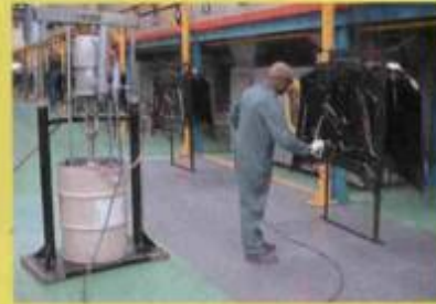
Aplicação de selantes a base de PVC.
