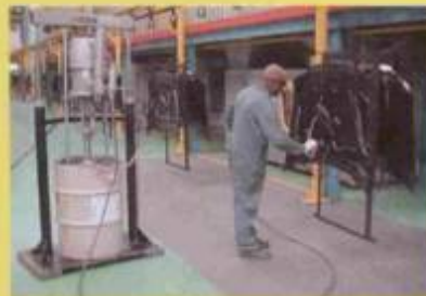
Aplicação de selantes a base de PVC.
