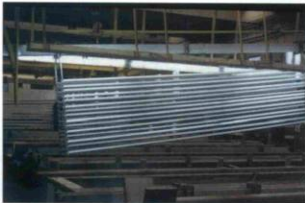
Linha de anodização antes da coloração da camada anódica
