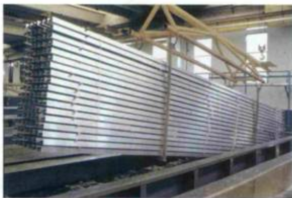
Pré-tratamento do alumínio (cromatização) antes da pintura - Linha horizontal
