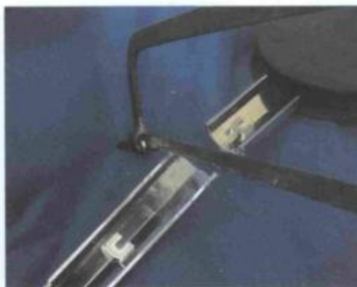
Figura 3: Ensaio de aderência (corte com serra).
