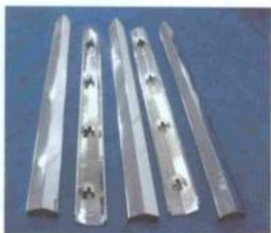
Figura 7: Peças após o ensaio em câmara de névoa salina.
