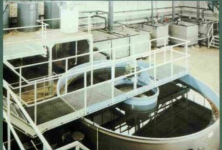
Desintoxicação e neutralização de uma galvanização
