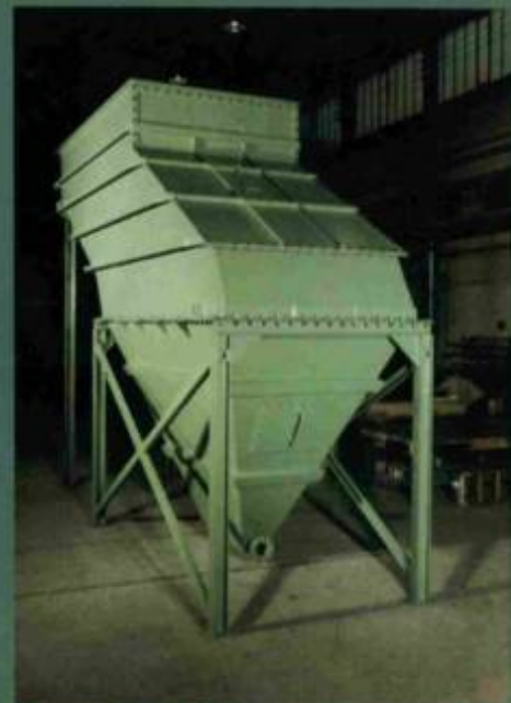
Separador de Lâminas - separação de lama de águas poluídas
