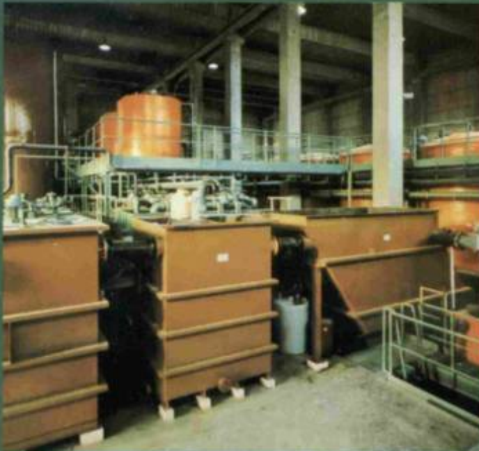
Neutralização - tratamento físico-químico de resíduos especiais
