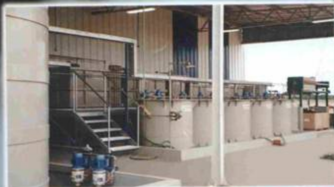
E.T.Es. para 10m³/h (fosfatização com pintura catafórica)
