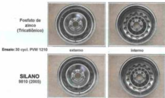
Figura 3 - Resultados obtidos após ensaio cíclico em rodas de aço fosfatizadas e com deposição de silanos
