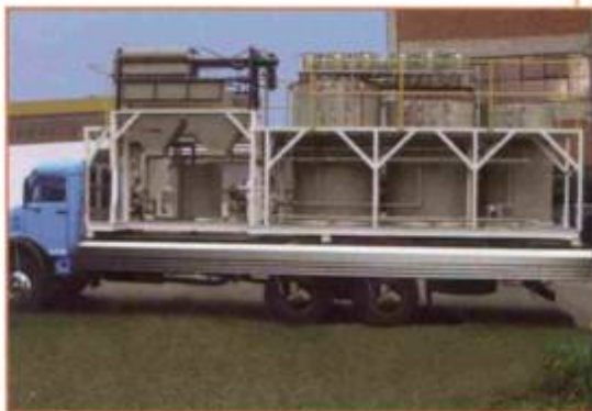
Estação de tratamento de efluentes móvel
