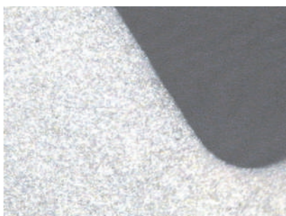
Figura 2 - Exemplo de isenção de ferrita delta em substrato isento de camada residual de fosfato de zinco prévia ao tratamento térmico
