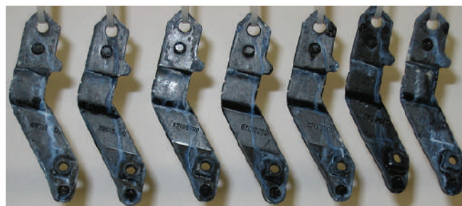
Figura 8 - Produtos de corrosão branca correndo sobre a superfície. Os pontos de fixação fornecem os íons de zinco livres (pouco ou nenhum zinco no furo superior, ponto de contato na deposição) enquanto hidróxidos alcançam vindos dos lados.
