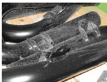
Figura 11 - Hidróxidos volumosos atravessando a camada (preta) de passivação devido a embalagem errada / secagem e condensação de água
