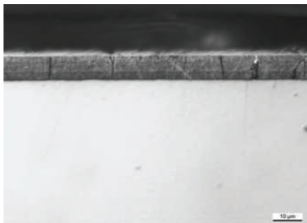
Figura 6 - Fissuras: camadas de zinco-níquel recristalizam durante as primeiras horas após o acabamento (a dureza aumenta em 24-48 h), recristalizando, formam-se fissuras que vão até o material de base, a formação de fissuras é influenciada por aditivos, mas (até agora) sempre ocorre
