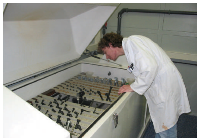
Figura 1 - Inspeção de corrosão em parafusos da Nedschroef Helmond BV- Holanda
