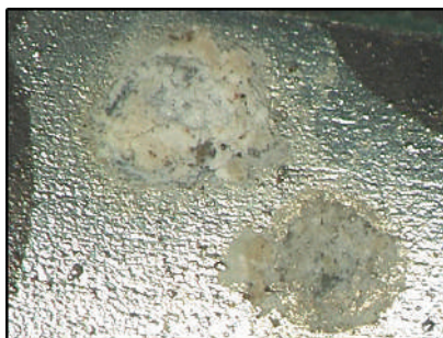
Figura 10 - Um ponto preto horizontal corroído totalmente coberto com sais brancos de corrosão volumosos (acumulando hidróxidos livres)
