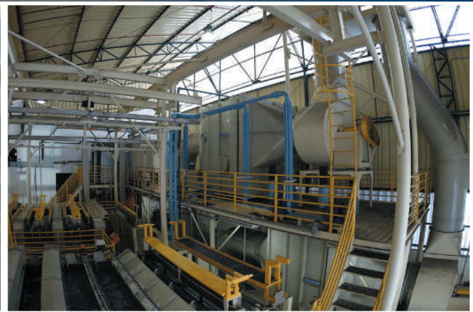
Lavadores / Exaustores com plataforma de manutenção
