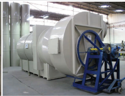
Sistema de Exaustão com Lavagem de Gases Horizontal
