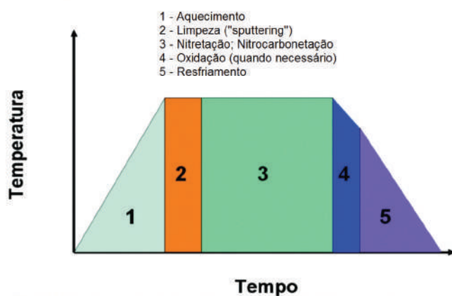
Figura 5. - Esquema de um processo típico de nitretação seguido de oxidação in situ .
