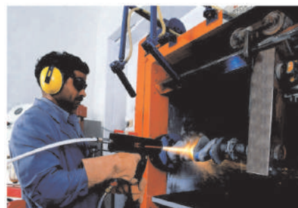
Aplicação pelo processo de arco elétrico
