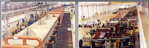
Instalações para tratamento químico de superfície (Tunnel, Strip, Autoclave ou Roll Pickling Lines) com sistemas integrados de proteção ambiental.
