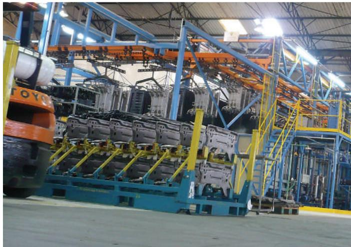
A nova linha possui capacidade para revestir até 540 m<sup>2</sup> de e-coat por hora
