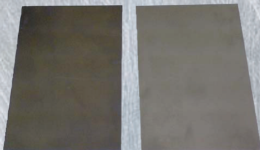
Superfície de aço tratada com SurTec 609 - ZetaCoat (à esquerda) e superfície não tratada (à direita)
