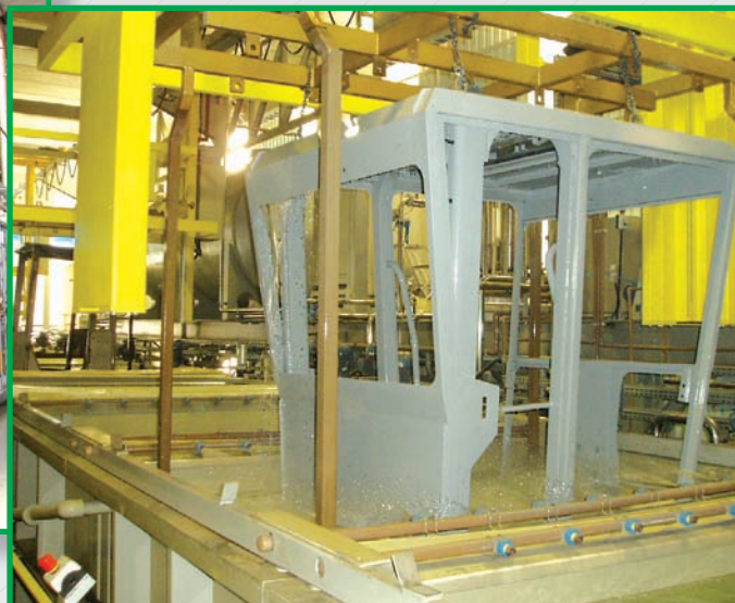
Linha de pintura eletroforética - Ecoat-KTL
