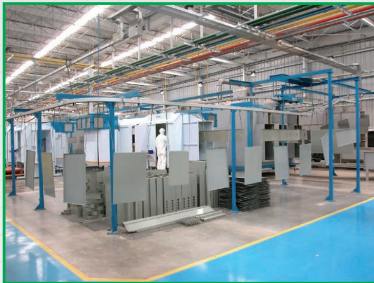
Linha de pintura a pó eletrostática contínua
