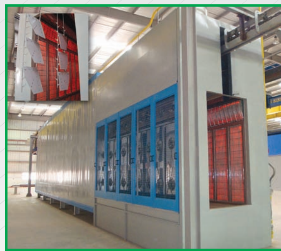
Estufa infravermelho por painéis catalíticos a gás IR
