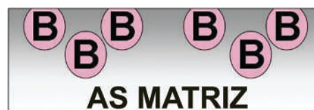
Figura 3 - Esquema da distribuição do butadieno na matriz acrilonitrila-estireno
