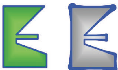
a) Deposição química b) Deposição eletrolítica
