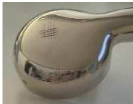
Figura 16 - Boa aderência no ensaio de grade
