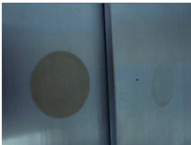
Superfície atacada Superfície revestida com X Figura 1: Ensaio de camada
