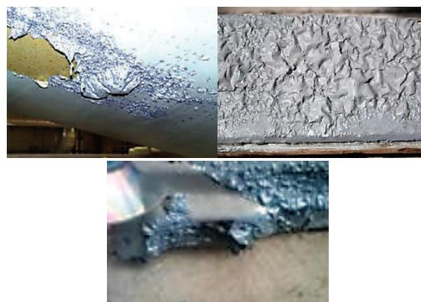
Remoção de tinta por deslocamento
