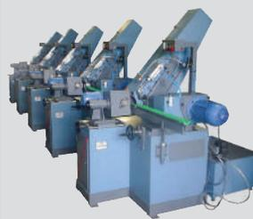
Solução definitiva em acabamentos como desbaste, lixamento, polimento, microacabamento, em tubos, barras, hastes, cilindros entre outras aplicações, nos mais diversos tipos de materiais.
