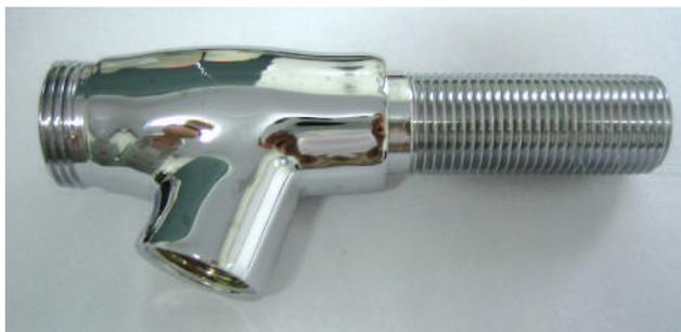
Figura 6 - Peças sem corrosão após 144 horas de névoa salina
