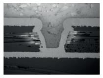
Figura 1: BMV processado com Neopact depois do processo de cobre ácido
