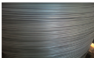
Arame após fosfatização eletrolítica e trefila
