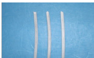
Arames após fosfatização de cálcio eletrolítica
