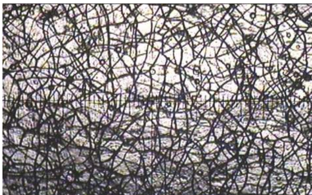
Figura 4 - Ensaio para determinação de microtrincas (fissuras) de depósito de cromo duro acelerado.
