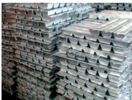
Foto 1: Lingote típico de Zamac
