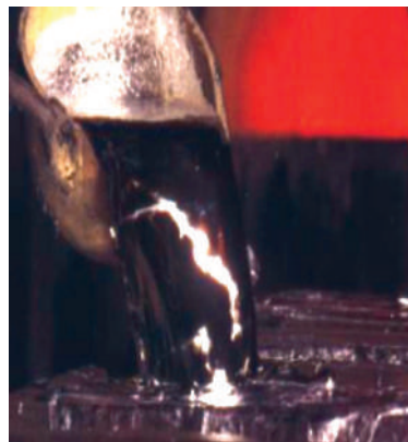
Foto 2: Liga de Zamac possui baixo ponto de fusão (aprox. 380°C)
