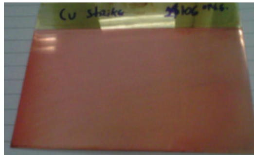
Foto 3: Painel de célula de Hull de um depósito típico de cobre alcalino strike
