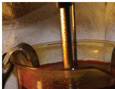
Figura 13 - O uso de supressores de névoa evita desperdício de ácido crômico
