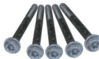
Figura 4: Zinco-níquel + passivador + selante na especificação PV 1209 após 4 semanas.
