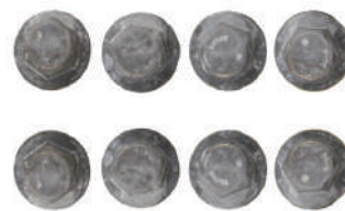
Figura 2: Processo Patentado 1000 (TNT 12) na especificação GMW 14872 após 80 ciclos.
