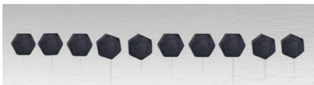
Figura 9: Painel AA6061 com parafusos de zinco-níquel preto, 40 ciclos na GMW 14862
