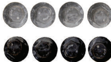
Figura 1: Processo pantenteado 1000 (TNT 12) e Processo pantenteado 1000B (TNT 12) após 1008 h de acordo com a ISO 9227
