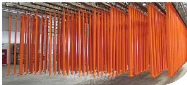
Linha para pré-tratamento e pintura de peças para sistemas de armazenagem, com capacidade de 10 toneladas por hora.
