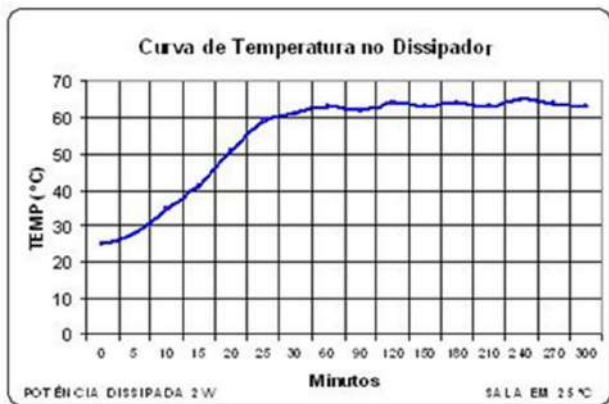
Figura 8. Gráfico da temperatura do dissipador em função do tempo.
