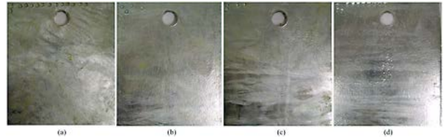
Figura 4. Qualidade superficial das amostras de acordo com o campo aplicado: (a) (3±6)x10 -4 T (b) (9±6)x10 -4 T (c) (14±6)x10 -4 T e (d) (18±6)x10 -4 T.
