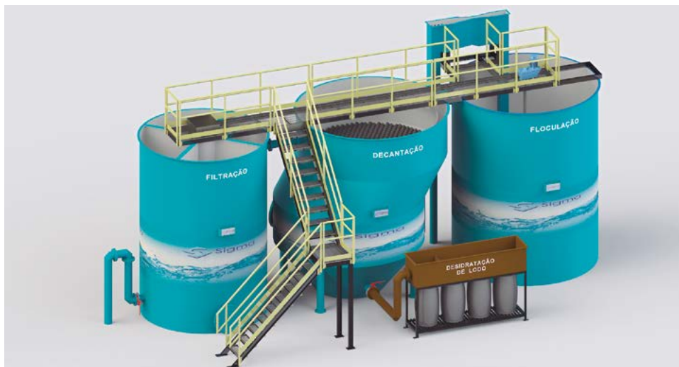
ETA Compacta Inteligente: sistema de floculação multiestágio com exclusiva tecnologia de retroalimentação de lodo proporciona flocos mais compactos e economia de reagentes químicos
