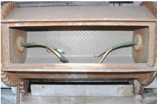
Fig. 1 - Cuba de tambor rotativo com furos de 4mm resultando 5,5% de área aberta nas suas faces maiores do prisma hexagonal e contato catódico insuficiente.
