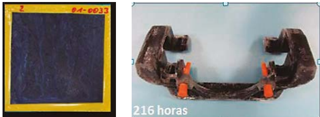
Figura 5: Corrosão branca precoce em ensaio de névoa salina - ISO 9227 de amostras convencionais em preto.
