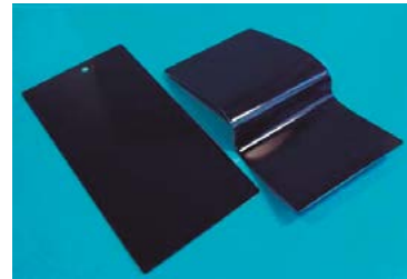
Figura 7b: peça dobrada após 1000 horas NSST / ISO 9227
