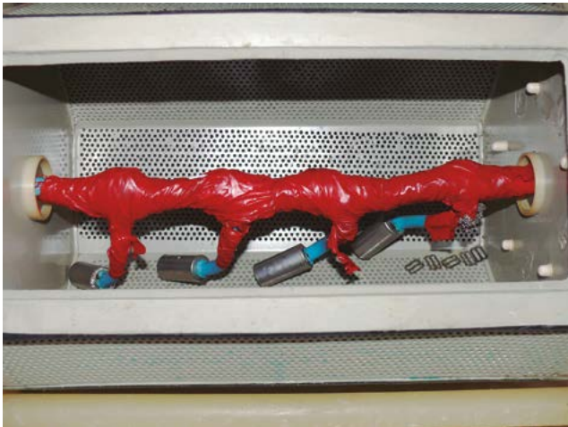
Fig. 3 - Cuba de tambor rotativo com furos de 2,8mm resultando 41% de área aberta nas suas faces maiores do prisma heptagonal e exemplo de contato catódico suficiente para até 400A.
