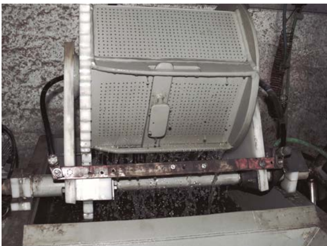
Fig. 2 - Cuba de tambor rotativo com furos de 3mm resultando 6,7% de área aberta nas suas faces maiores do prisma hexagonal.
